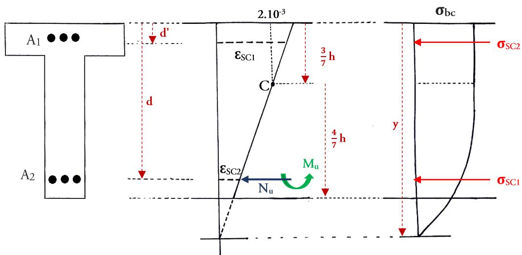
Les armatures d'une section en T soumise à la flexion composée et entièrement comprimée sont les mêmes que celles de la section rectangulaire de dimensions " $b_0 * h$ " soumise à :
