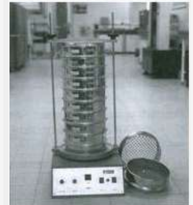
une série de tamis placée sur la table vibrante
