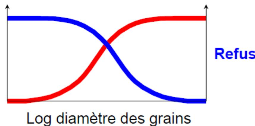
La courbe granulométrique représente le pourcentage en poids des grains de dimension inférieure à  $D$  en fonction de la dimension  $D$  d'un grain. On l'obtient par tamisage pour les grains de dimension supérieure à 80 µm et par densimétrie pour les grains de dimension inférieure à 80 µm. En densimétrie,  $D$  est le diamètre d'une sphère de même poids que le grain. En tamisage c'est la maille du tamis.
